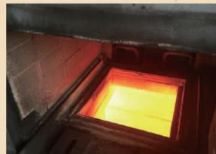
乾燥した瓦は1,050°Cのガス窯で焼き上げられ、約20時間密閉し、いぶされます。この時に菊間瓦特有のいぶし銀色の光沢ができます。
