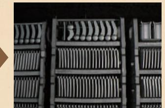
焼きあがった瓦は1枚1枚打音検査を行い、中に空洞や損傷が無いことを丁寧に確認したのち、合格したものが道後温泉本館の南棟(棟瓦葺)に葺かれます。
