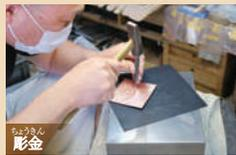
③鏝を使用して金属を彫り込みます(①～③の工程を数回繰り返します)
