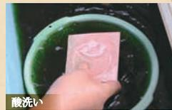
②酸化した銅の酸化膜を除去します
